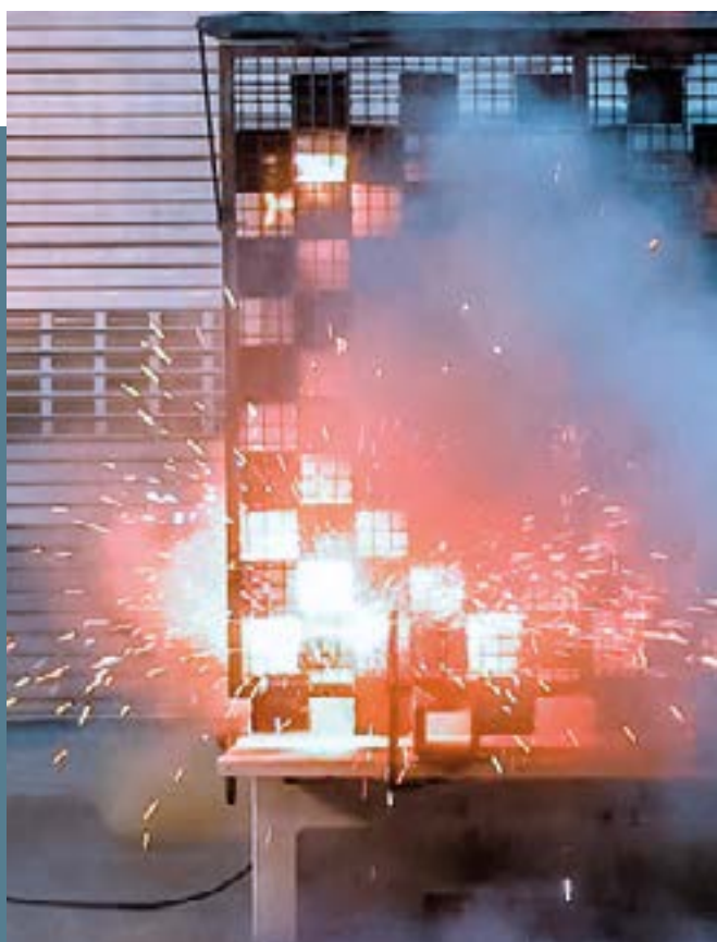
Ívzárlattal szembeni ellenállás próba I.
