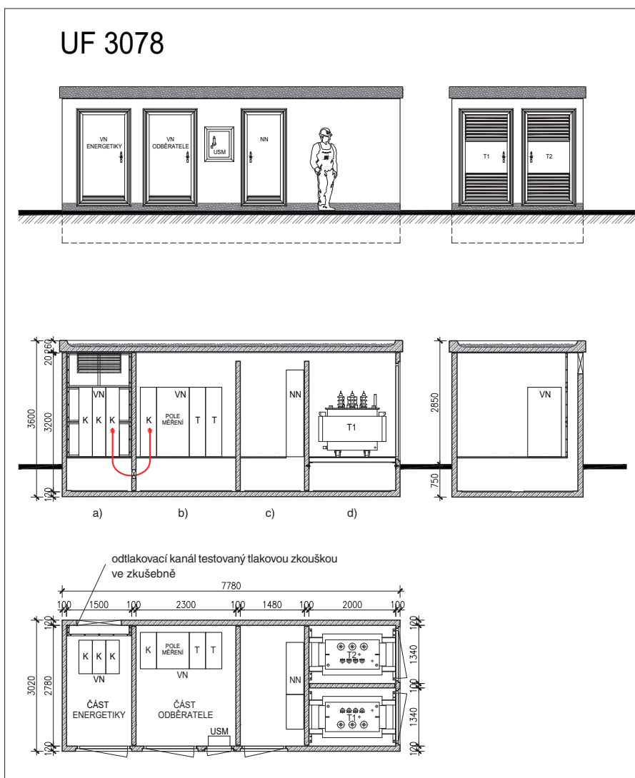
Obr. 2. Stavební uspořádání blokované transformovny s oddělenými částmi distributora a odběratele a) vn část distributora, b) vn část odběratele, c) nn část odběratele, d) kobky s transformátory
