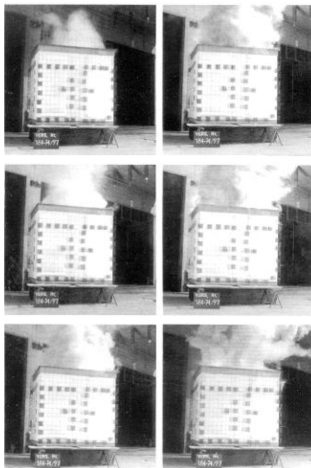
Zkouška na vnitřní obloukový zkrat ve stanici s možností vstupu osob
