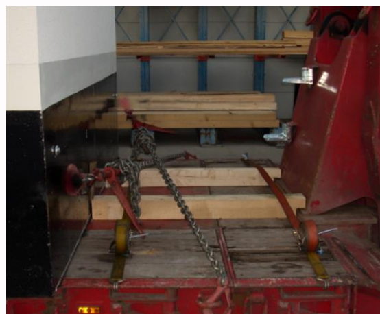
Obr. 16 Blokování pomocí klanic nebo hranolů
