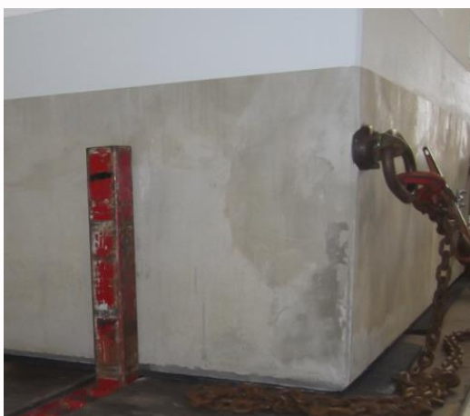
Obr. 16 Blokování pomocí klanic nebo hranolů
