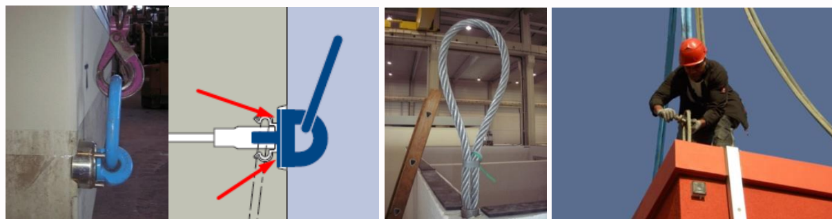
Obr. 21: Příklady správně zašroubovaných vázacích prostředků
