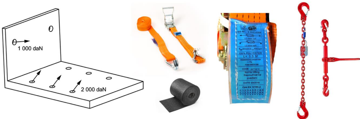
Obr. 5: Prostředky pro zajištění nákladu a vázací body na vozidle
