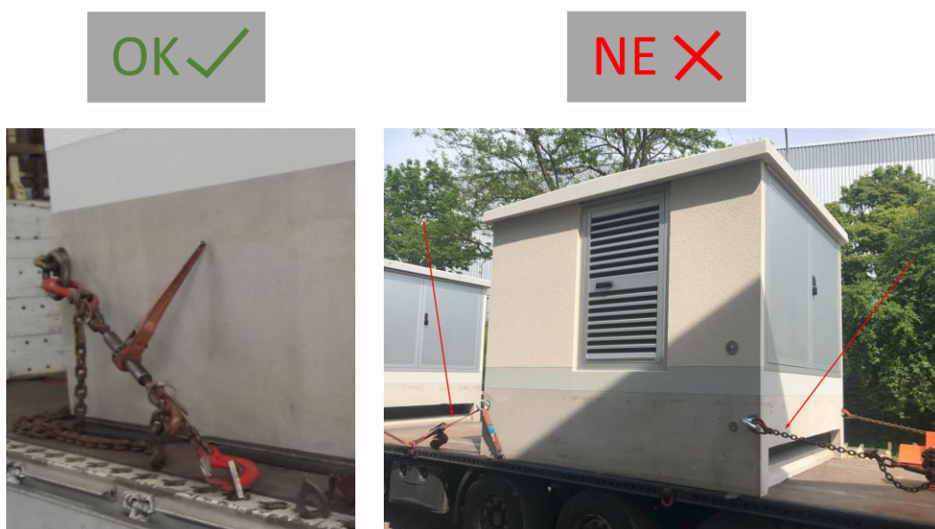
Obr. 10: Vázací body na vnějším lici podélných stěn
